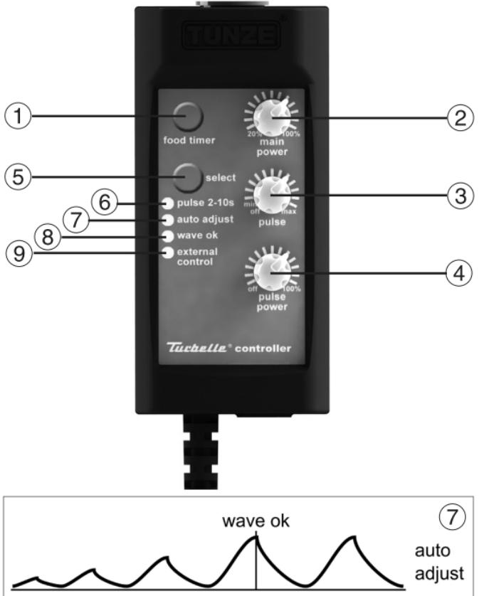
Condizione di fabbrica: con "select" è inserita l'impostazione "pulse 2-10s" (9), le manopole di regolazione "main power" (2) e "pulse power" (4) sono impostate sull'80% circa. La manopola di regolazione "pulse" si trova su "off".
