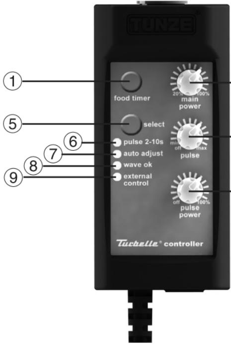
In questa fase l'acquario andrebbe tenuto d'occhio. Non appena raggiunta la frequenza di risonanza, si nota un evidente movimento dell'acqua. La funzione "auto adjust" (7) può essere arrestata premendo brevemente il tasto "select" (5); ora si illumina la spia "wave ok" (8).
