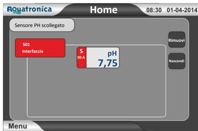
Quando scollegate un sensore, dopo alcuni secondi il controller mostrerà un messaggio di disconnessione.
