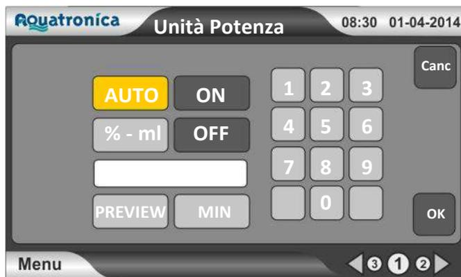
1. Entrare nel Menu Unità di potenza -> Comando Manuale, premere sulla presa che volete usare e selezionate ON o OFF e poi OK
