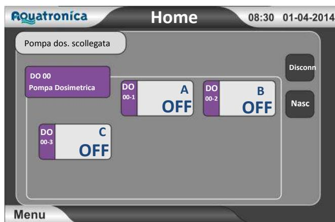
Quando si scollega una pompa dosimetrica, dopo pochi secondi il controller mostra il messaggio di disconnessione. Si hanno due possibilità:
