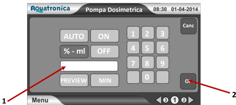
Per dosare una specifica quantità di liquido, scrivete la quantità (ml) nello spazio apposito (1) e premete OK (2). Dopo di che la pompa dosimetrica funzionerà finché la quantità di liquido non è esaurita.
